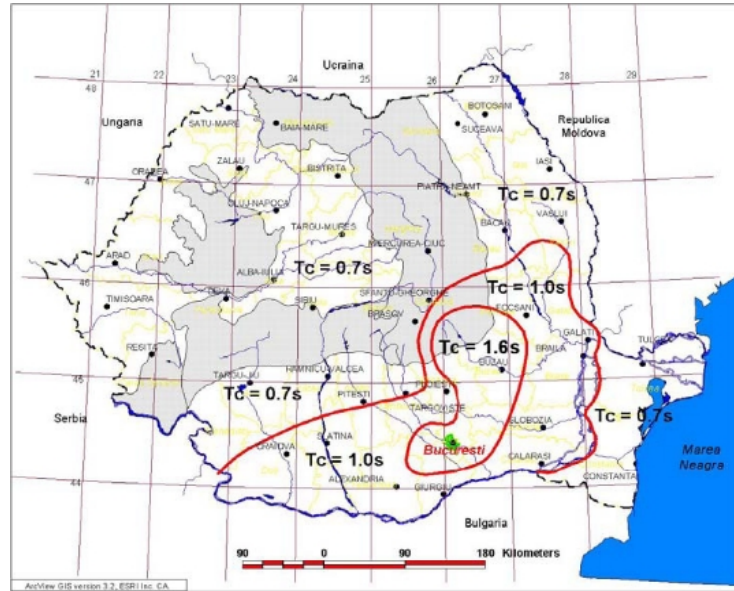
Figura nr. 17 - Zonarea teritoriului Romaniei in termeni de perioada de control (colt), Tc a spectrului de raspuns
